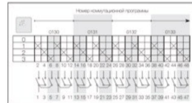
Многопозиционные переключатели с нулевым положением (0-1-2-3-...)
